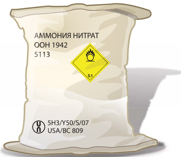
Рис. 6.1. Пример маркировки мешка с нитратом аммония
