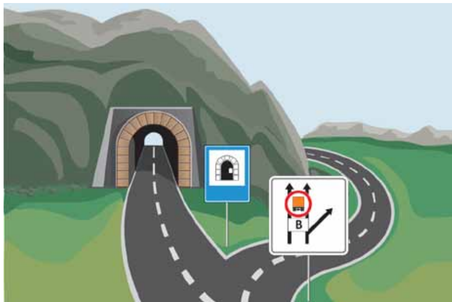
Рис. 6.16. Пример установки дорожного знака определяющего категорию тоннеля
